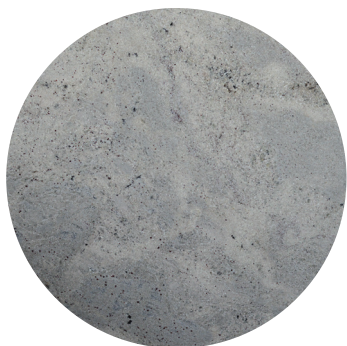
Kámen žulový obklad šambrán oken a vstupu
